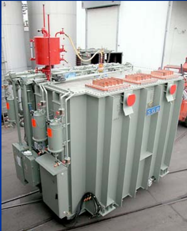
Transformador para hornos de arco eléctrico
