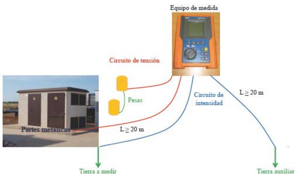
Figura A.84. Medida de la tensión de contacto en un CT.
