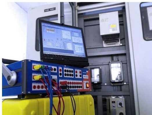
Figura A.126. Unidad de prueba de relés y calibrador de alta tensión. Fuente: Amicron.
