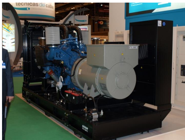
Figura A.180. Grupo electrógeno. Fuente: Gesan.
