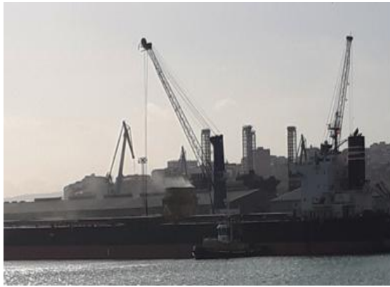
Figura 2.20. Tolva aspirante en el puerto interior que minimiza la cantidad de polvo que se genera al mover ciertas mercancías (febrero de 2025).
