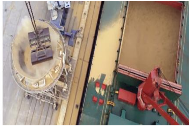
Figura 2.20. Tolva aspirante en el puerto interior que minimiza la cantidad de polvo que se genera al mover ciertas mercancías (febrero de 2025).
